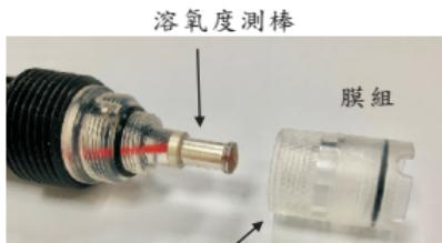
(5) 安裝半透膜套組及充填電解液後，如發現半透膜套組內有小氣泡是正常的。但正中間的工作區不可以有泡泡。
