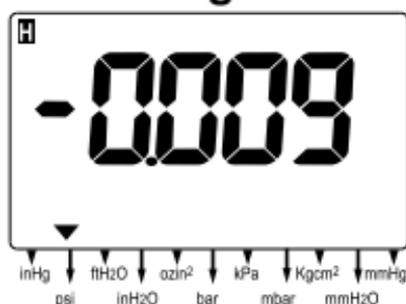
UNIT 按一下就會有各種單位循環的出現在螢幕的下方(看Fig.G&H)。這些單位如下：inHg, psi, ftH<sub>2</sub>O, inH<sub>2</sub>O, ozin<sup>2</sup>, bar, kPa, mBar, Kgcm<sup>2</sup>, mmH<sub>2</sub>O, mmHg。
