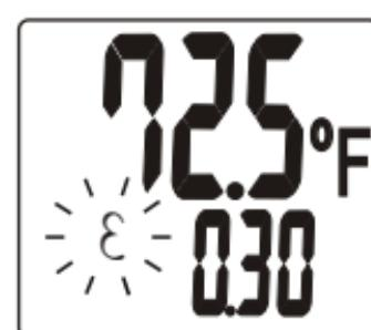
進入放射率調整模式，請扣住板機同時輕按**MODE**鍵，螢幕即出現閃爍的  $\epsilon$ ，此時可參考物質放射率表，調整正確的值，按( $^{\circ}\text{F}/^{\circ}\text{C}/\blacktriangledown$ )鍵減少數值，以及( $\blacktriangle/\blacktriangleright$ )鍵增加數值。本儀器放射率值可調整範圍為 **0.3-1.0**。
